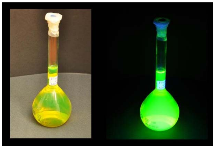
Figura 14 – Solução básica de fluoresceína sob luz natural e sob luz ultra violeta.
