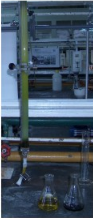
Figura 6 – coluna de cromatografia para separação das várias substâncias dos espinafres.
