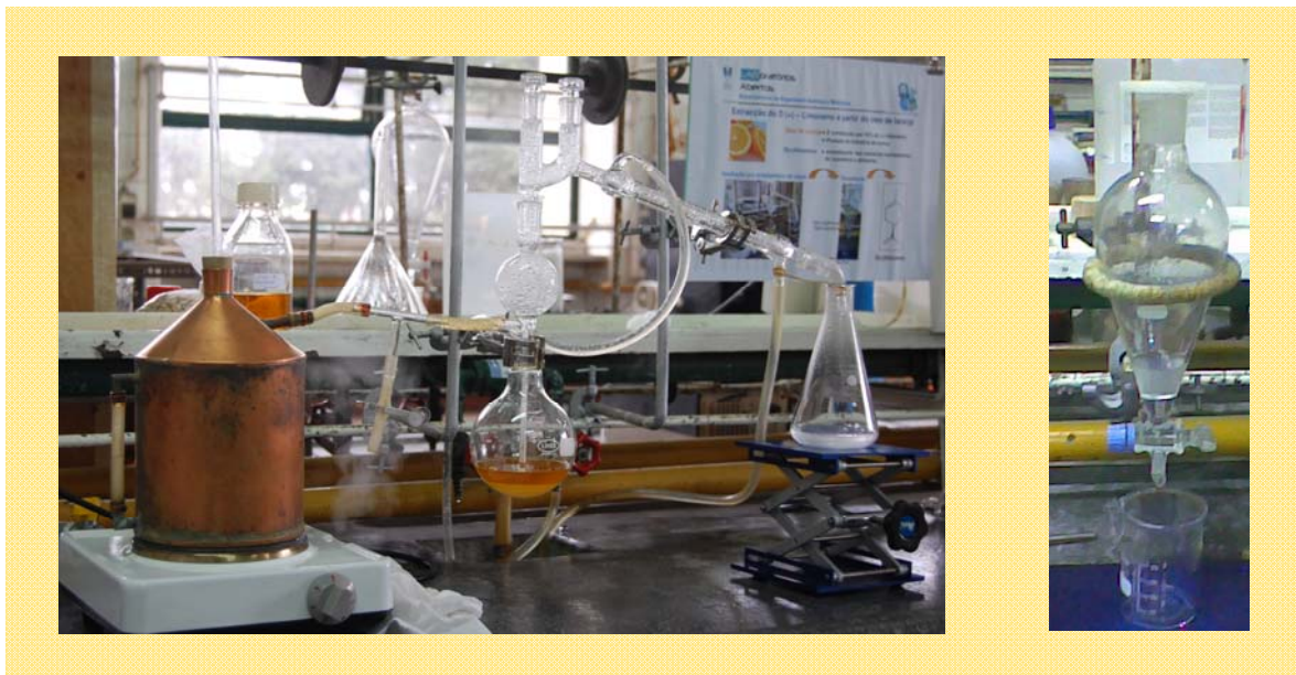
Figura 1 - Destilação por arrastamento de vapor do óleo de laranja.
