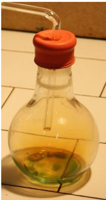
Fig. 26 - Formação do nitrocomplexo de cobre - solução verde - por adição de ácido nítrico.
