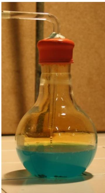
Fig. 24 - Passagem da água para a solução com o cobre e formação do aquocomplexo azul
