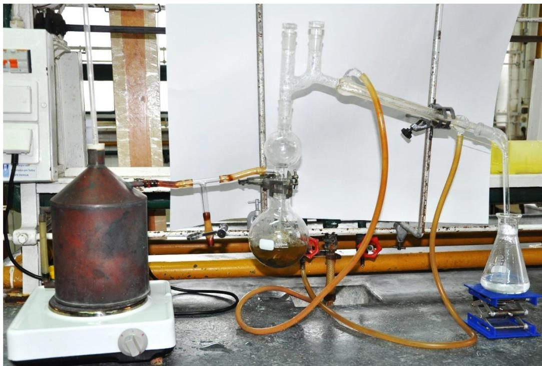
Figura 3 - Destilação por arrastamento de vapor das folhas de eucalipto
