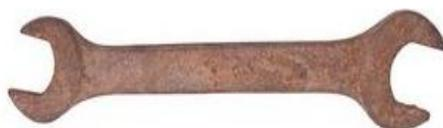
Figura 2 – Peça enferrujada devido a um processo de combustão lenta
