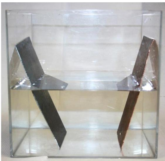
Fig. 18 - Placas de cobre e alumínio dentro de uma solução de um eletrólito forte.
