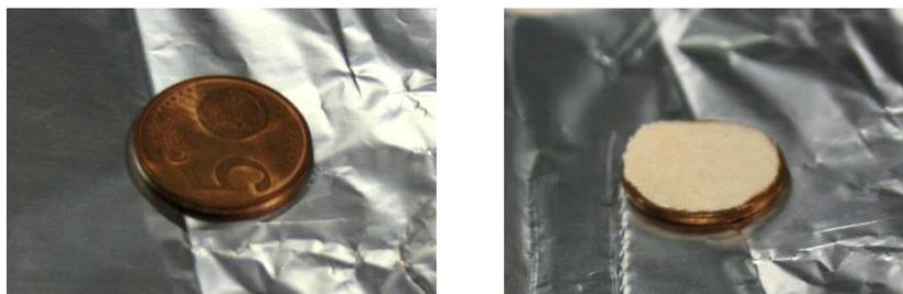
Fig. 14 - Construção da pilha - Moeda de cobre, pano embebido num eletrólito forte
