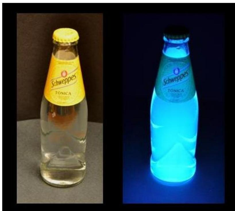
Figura 20 – Água tônica e solução de fluoresceína sob luz natural e luz ultra violeta.
