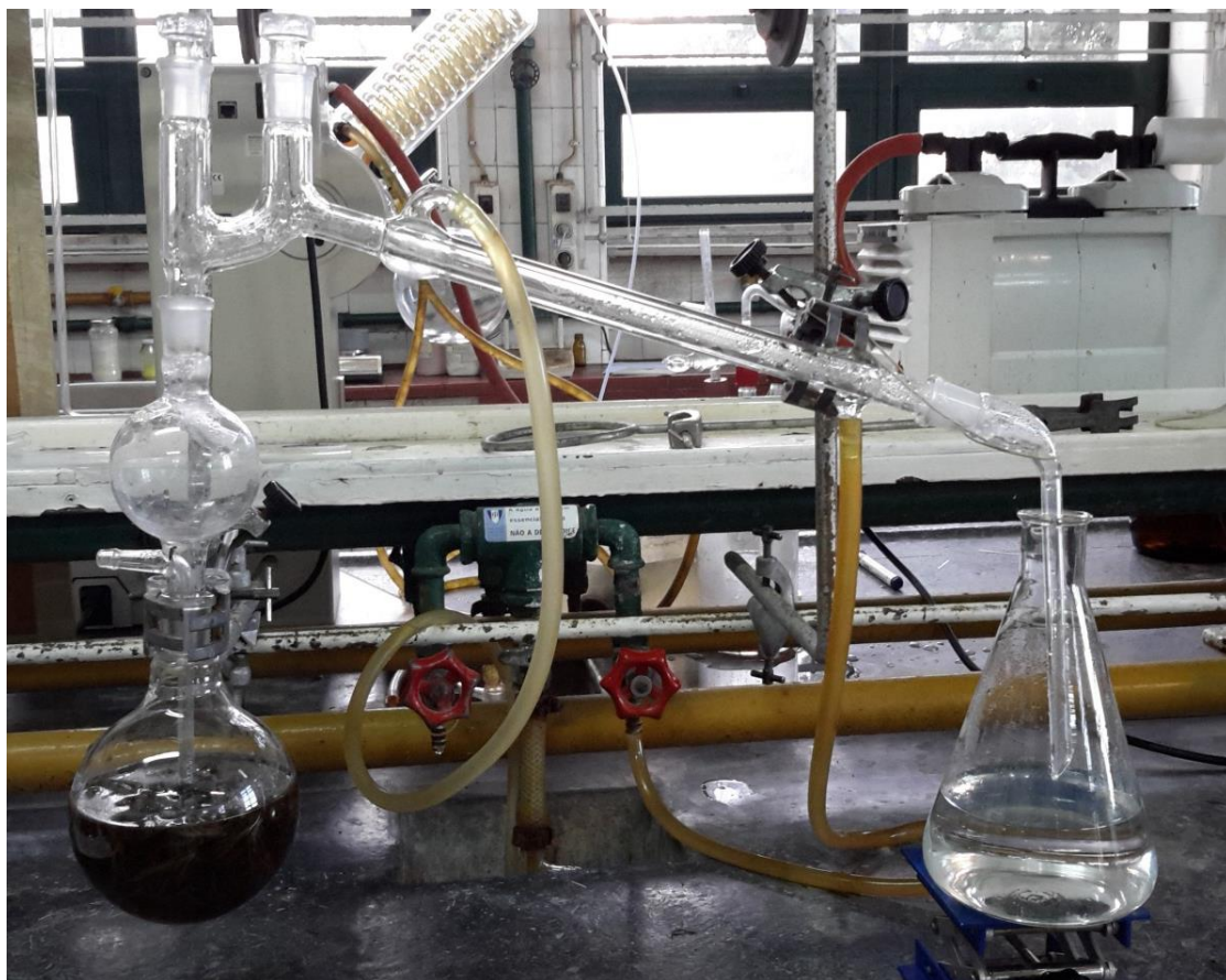
Figura 5 - Destilação por arrastamento de vapor das folhas e flores de alfazema.
