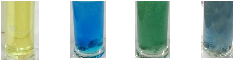
Fig. 6 - Solução de vanádio nos vários estados de oxidação. Da esquerda para a direita, V(V), V(IV), V(III) e V(II).
