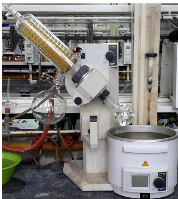
Figura 7 – Destilação do diclorometano num rotavapor
