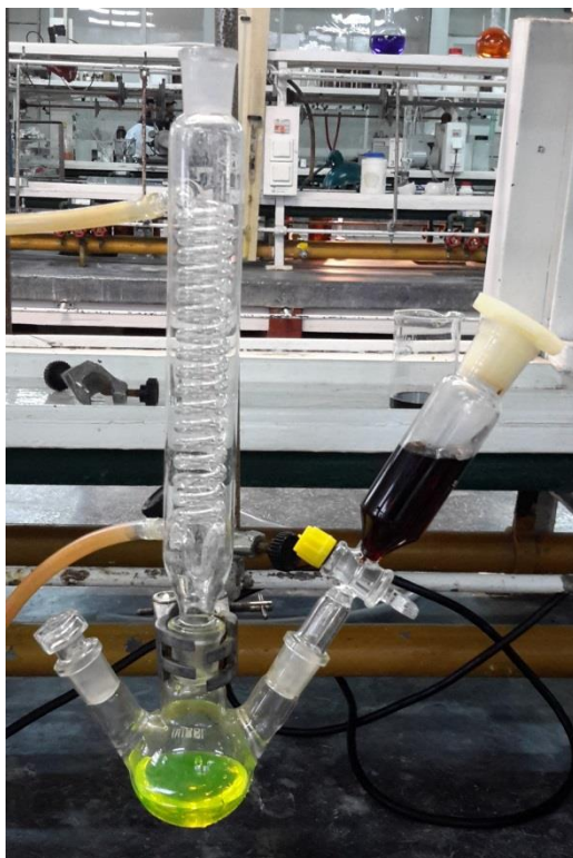
Figura 17 – Montagem para a reacção de formação da eosina.
