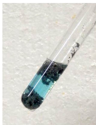
Fig. 19 - Solução aquosa de Crómio II com zinco
