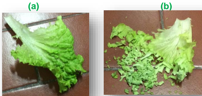
Figura 5 Alface: a) à temperatura ambiente; b) depois de imersa em nitrogénio líquido (estilhaça)
