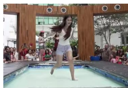
Diferença entre fluido Newtoniano (água) e fluido não-Newtoniano (fluido dilatante – farinha de amido de milho) ( https://www.youtube.com/watch?v=D-wxnID2q4A )
