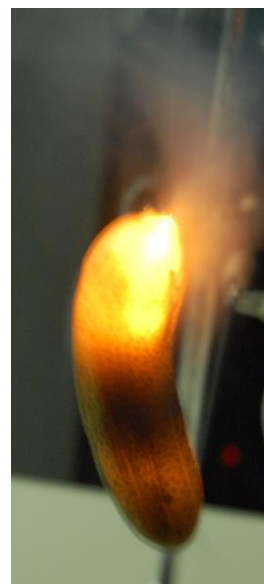
Figura 3 – Brilho amarelo provocado pelos iões de sódio presentes no pepino quando se faz passar uma corrente elétrica através deste.
