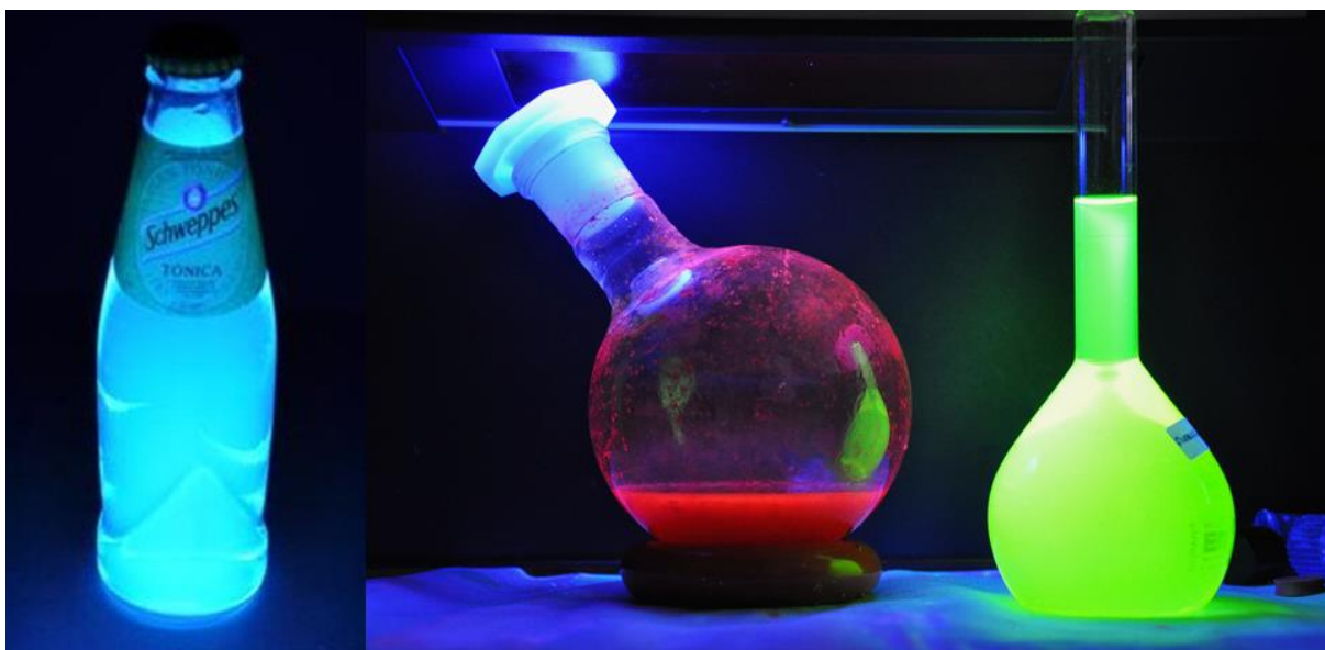
Figura 31 – Água tónica, solução de eosina e de fluoresceína sob luz ultra violeta.
