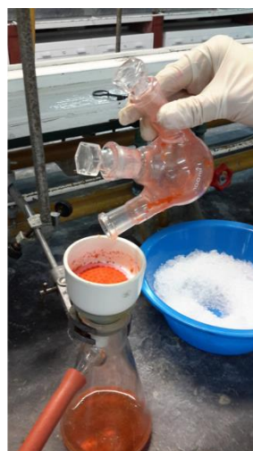
Figura 18 – Arrefecimento da mistura reacional e filtração a vácuo da eosina.
