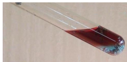
Fig. 21 - Reação de Crómio II com acetato de sódio.
