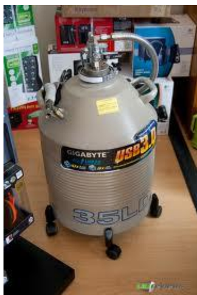
Fig. 2 - Dewar para transporte e armazenamento de azoto líquido
