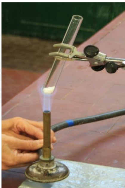
Fig. 7 - Aquecimento do clorato de potássio com um bico de bunsen.
